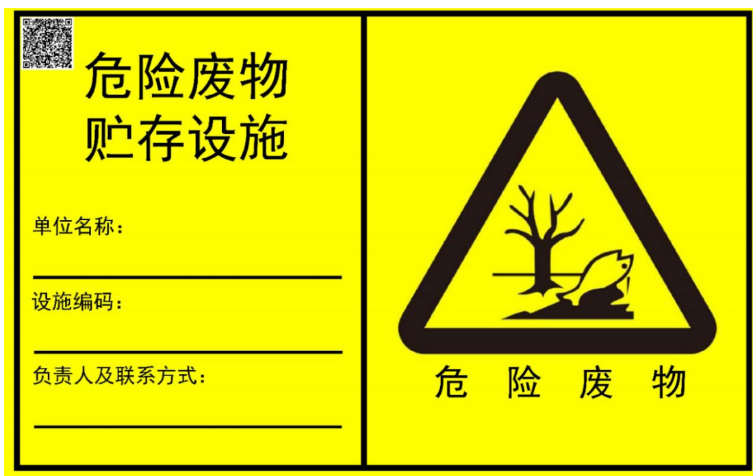
图 4-3 危险废物贮存设施标志（横版）
